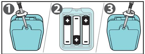
1. À l'aide d'un tournevis, ouvrir le couvercle du compartiment des piles.
