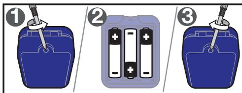
1. À l'aide d'un tournevis, ouvrir le couvercle du compartiment des piles.
